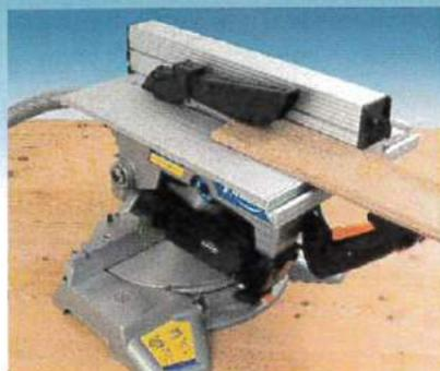
Nuovo piano superiore, più grande, per lavori ausiliari. Il taglio è regolabile in altezza da 0-55 mm e dispone di una scala millimetrata per la misurazione. Permette di adattare una squadra (opzionale) per tagli angolari (vedi accessori opzionali pag. 4).
