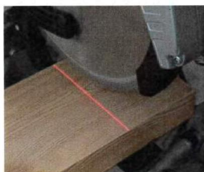
Dotata di laser di precisione per facilitare il taglio. Attivazione automatica dello stesso, all'accensione della macchina. Include interruttore on/off, ideale per disattivarlo nei lavori su piano superiore. Il dispositivo laser è montato direttamente sul disco della sega, in modo che il raggio laser mantenga la precisione in qualsiasi posizione di taglio.
