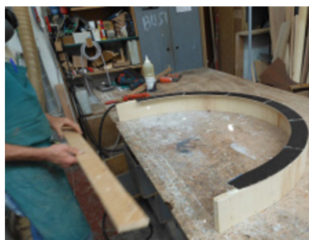
Esempio di costruzione controllelaio con curvatura superiore (profilo T Flex + battuta Profile)
